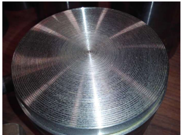
(d) Roughening of disk bottom surface.
